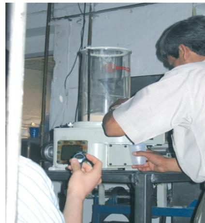
Operación del dosificador de la premezcla de micronutrientes para la masa de maíz nixtamalizado
