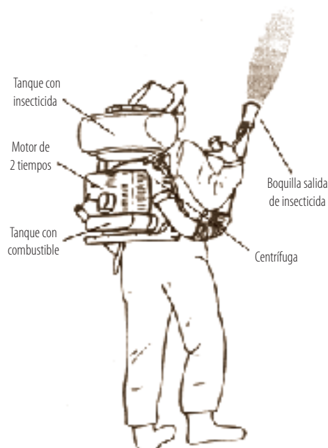
Figura 5 Motomochila para rociados de volumen bajo. (Tomado y modificado de: Lacey y Kaya, 2000)
